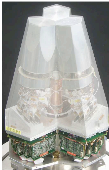
Abbildung 3.3: Schematischer Aufbau eines Testkryostaten und Foto eines AGATA-Tripel-Kryostaten mit transparenter Endkappe
