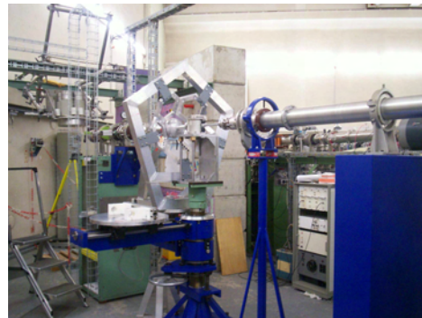
(c) Schließen des Rohres und Kalibrierung mit Theodolit und Nivelliergerät
