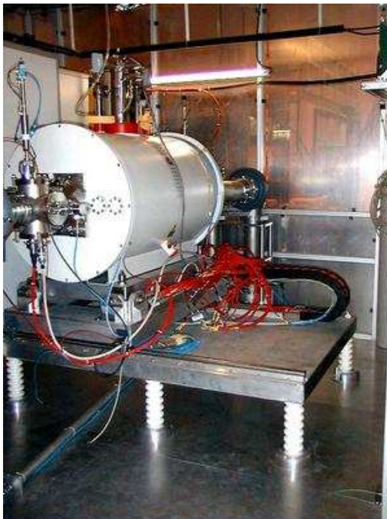
Abbildung 2.4: Die REX-trap Penning-Falle (aus [29])
