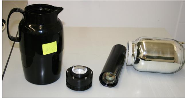
Abbildung 12: Teile des Detektors: Kunststoffaußenhülle, Lichtwellenleiter, Photomultiplier, Dewargefäß von links nach rechts.
