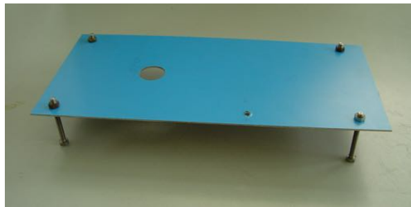
Abbildung 4.1: Konstruktion und Halterung zur Platzierung der offenen Alpha-Quelle. Diese sollte möglichst nah an den Detektor gebracht werden, ohne dass ein Teil des aktiven Materials auf den Detektor übertragen wird. Die Maße sind so gewählt, dass die Konstruktion in der Detektorbox platziert werden kann. Die Höhe kann durch die Schrauben wahlweise eingestellt werden.
