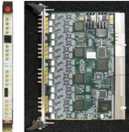
Abbildung 3.5: Vorder- und Seitenansicht eines Pixie-16 Moduls. Neben analogen Outputs zu den einzelnen Vorverstärkersignalen ist auf der Vorderseite die digitale Verbindung zu den Gassiplex-Chips zu sehen.[9]
