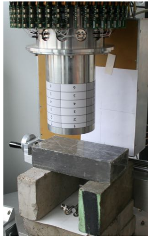
Abbildung 3.8: Aufbau für große Streuwinkel. Der HPGe-Detektor ist durch Blei von direkter Bestrahlung durch die Quelle abgeschirmt. Die zu erwartende Ereignisrate ist deutlich geringer.
