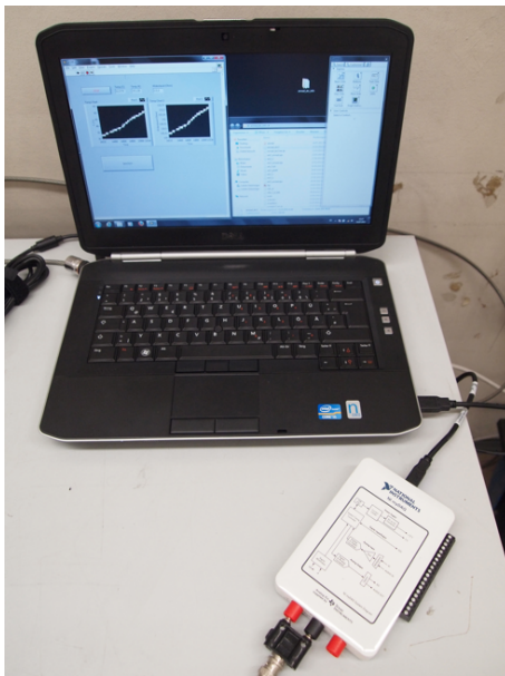
Abbildung 3.4.: Temperatúrauslese mittels Laptop und myDAQ-Schnittstelle ermöglicht die Überwachung des Temperaturverlaufs. So wird sichergestellt, dass die zulässige Höchsttemperatur von 102^{\circ}\text{C} nicht überschritten wird.
