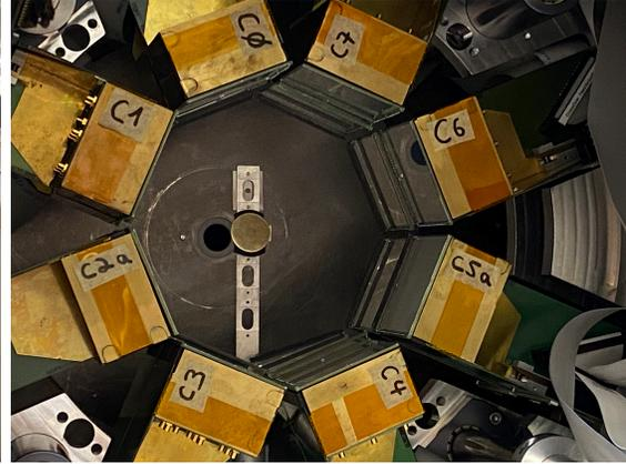
Abbildung 6: Detektoren und Targethalterung. Hier mit verbauter Tripel- $\alpha$ -Quelle.
