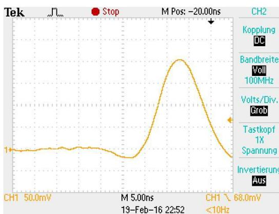
Abbildung 21: Anpassung des Signals bei der CF-Einstellung mit einem Delay von etwa 9 ns
