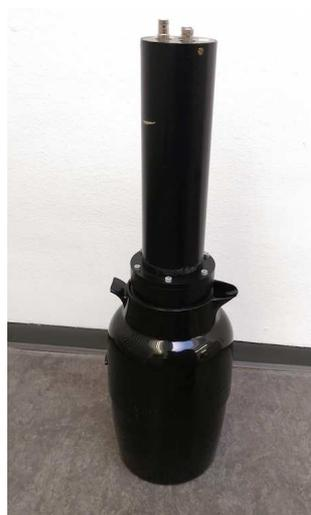
Abbildung 12: Aufbau der Kamiokanne: (a) Glasschicht, (b) Reflexionsschicht aus Silber, (c) Kunststoffschicht. Aufbau des Kamiokannedetektors: 1. Kamiokanne, 2. Lichtwellenleiter, 3. Photomultiplier. (Quelle Bild links: [10])
