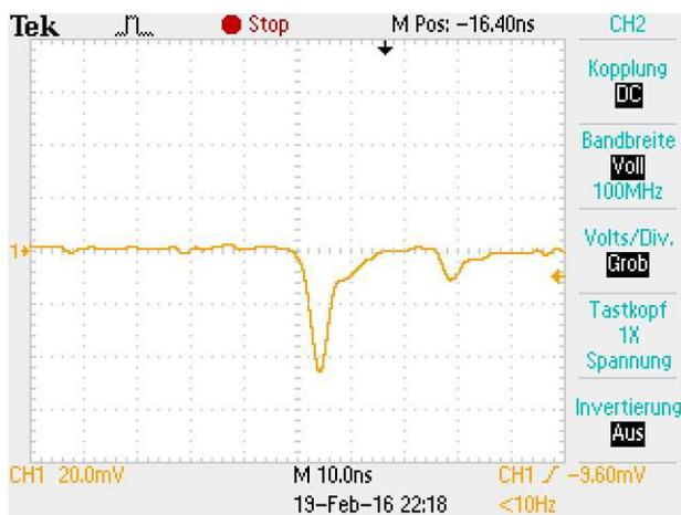
Abbildung 17: Oszilloskopsignal des direkt an der Anode des PMT abgegriffenen Signals.
