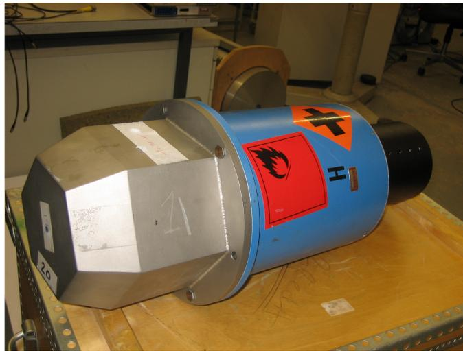
Abbildung 2.6: Ein hexagonaler Nordball-Detektor
