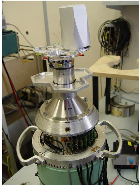
Abbildung 2.5: Miniball Triple Kryostat mit einer montierten Kapsel
